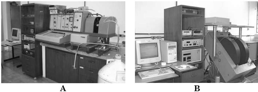
**Figura 4:** Espectrômetros utilizados nos trabalhos. (A) Varian E-4, Banda X (B) Espectrômetro Banda K utilizados no laboratório.
